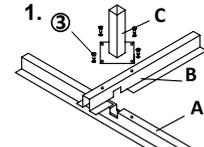
Diagrama 1. Para conectar el Conector (C) y la Cruz de Base (A) & (B), use los 4 pernos M10 x 20 (4). Véa el diagrama llamado "Cómo conectar la base".
