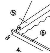
Diagrama 4. Conectar la barra (izquierda y derecha nº 6) en el extremo de la barra frontal (nº 5). Repetir el mismo proceso para conectar el lado opuesto.
