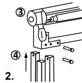
Diagrama 2. Insertar el rodillo (nº 3) sobre la parte superior del poste (sección intermedia nº 4), conecte las dos partes entre sí mediante pernos M8 x 60mm. Repetir el mismo proceso y conectar el otro lado.
