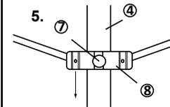
Diagrama 5. Para ajustar la altura del toldo en el brazo angular (nº 6) floje los pernos (nº 7), utilice la manivela para extender la tela del toldo (la barra de ajuste nº 8 se moverá). Una vez que usted haya configurado la altura sólo ajuste el perno, (nº 7).
