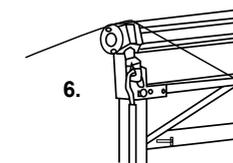
Diagrama 6. Utilice el perno M8 x 50 mm y M8 x 35 mm para instalar las barras inclinadas a ambos lados. El toldo está montado y listo para usar.
