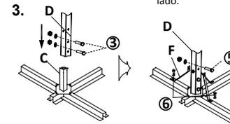
Diagrama 3. Se necesitarán de 2 personas para realizar este procedimiento. Deslice el poste de soporte (D) en las patas (fig.1). Atornille y ajuste los M8x50 a los dos tornillos inferiores de las patas (3), a continuación coja las barras de soporte, atornille y ajuste como se muestra con los (5) M8x60 y los (6) M8x20.
